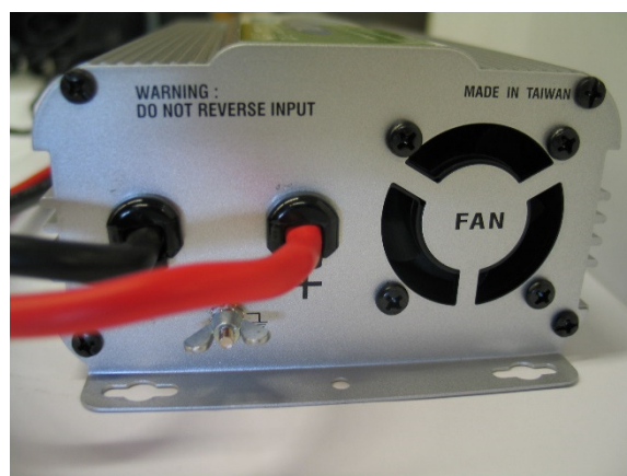
Bild 6: Rückseite Akku Anschlussleitungen, PE Anschlusspunkt
